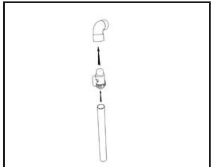
25c - Coller le coude, la vanne d'arrêt et le tuyau de 1 m. Mettre à longueur le tuyau en fonction de la configuration du sol.
